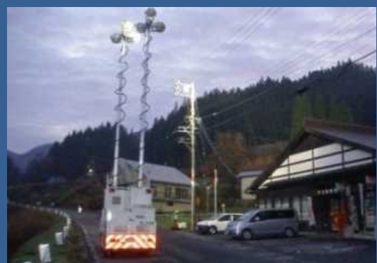
夜間監視作業を照らす照明車
