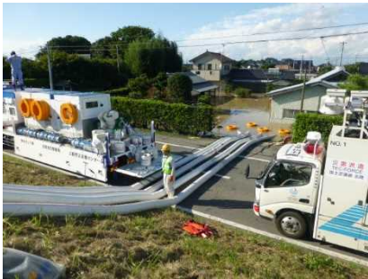
排水ポンプ車による排水状況
